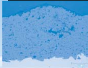
Cr 2 O 3 – porosity 5,9 % hardness 1100 - 1200 Hv
